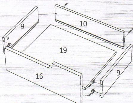
Шурупами 3,5\*16 привернуть петли к деталям 17 и 18. Закрепить фасады на корпус изделия и отрегулировать петлями. Вкатить ящики в корпус шкафа. Вставить полкодержатели в готовые отверстия деталей 1 и 2. Установить полки. Вставить заглушки на видимые euroшурупы. Установить штангу.
