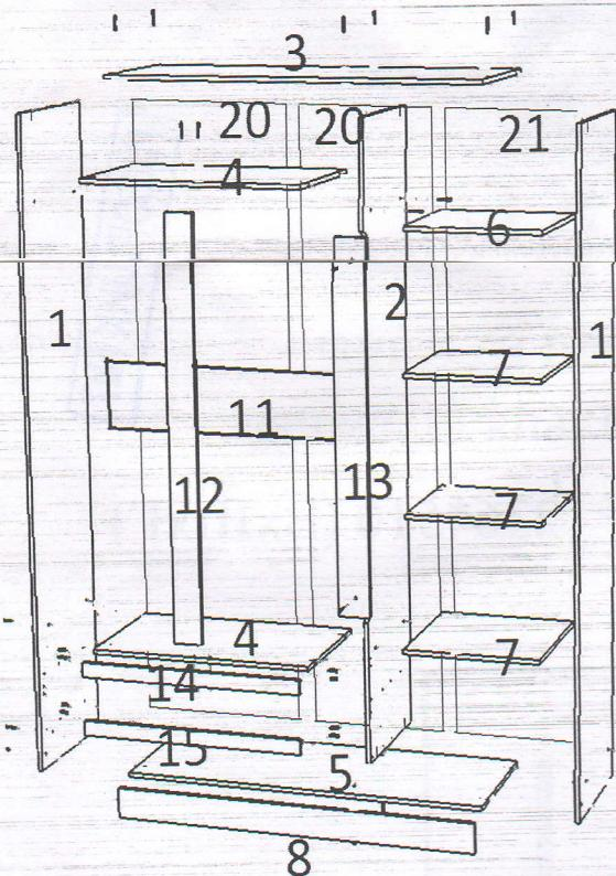
Прибить гвоздями опоры к детали 1. Шурупами 3,5\*16 привернуть направляющие (колесом вперед) к деталям 1 и 2, в готовые отверстия этих деталей вставить шканты. К деталям 1 и 2 шурупами привернуть штангодержатели.
